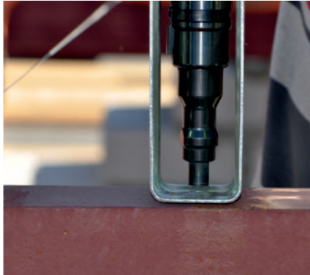
пороховой монтажный пистолет HILTI DX
